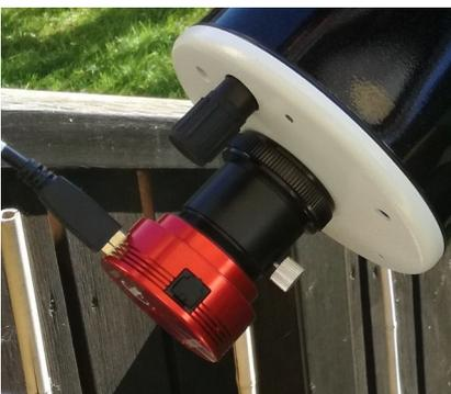
Der Steckhülsenadapter ermöglicht ein unkompliziertes Rotieren der Kamera.
