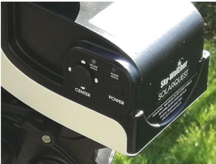
Über den 8-Wege Joystick der Montierung kann langsam über die Sonnenscheibe geschwenkt werden.
