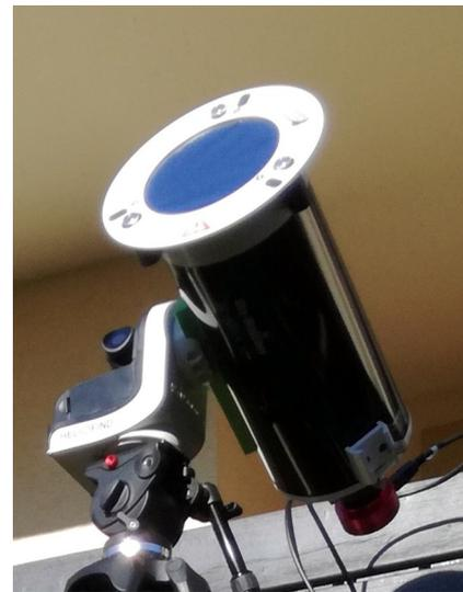
In Primärbrennweite ist über einen 1,25"-Steckhülsenadapter eine monochrome Planetenkamera *ZWO ASI120MM-S* mit vorgeschaltetem *Baader Solar Continuum* Kontrastfilter angeschlossen. Durch den Solar Continuum Filter wird der Kontrast der Photosphäre deutlich gesteigert und negative Seeing-Effekte werden reduziert.
